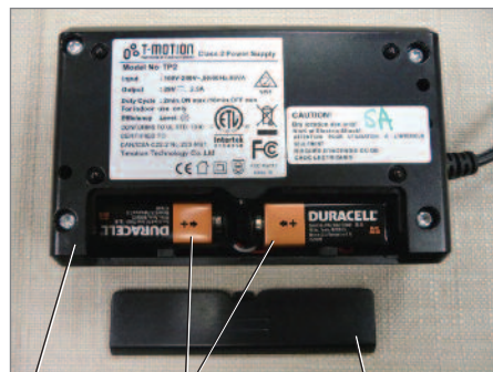
Source d'alimentation 2 piles alcalines de 9 volts Couvercle de la pile
