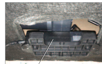
Coloque la fuente de alimentación sobre el estante
