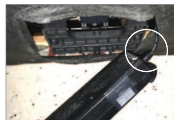
Conecte el conector del motor directamente a la fuente de alimentación para las unidades modulares y sillones
