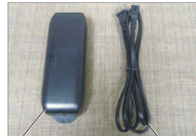
Transformador de corriente Cordón de 120 voltios
