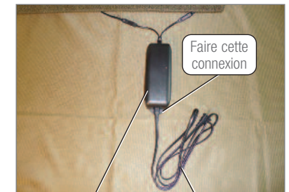
Transformateur électrique Cordon électrique de 120 volts
