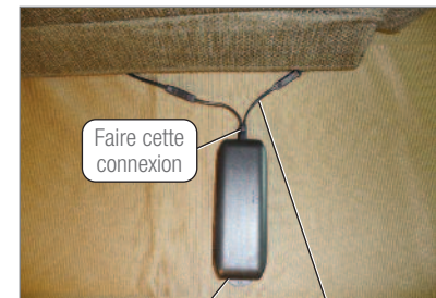
Transformateur électrique Petit câble en Y
