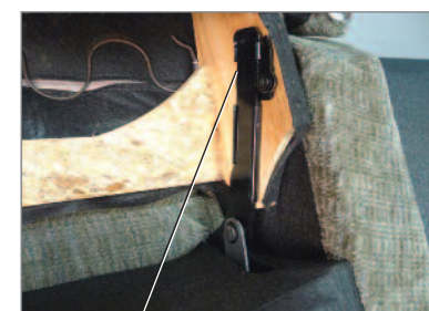
Soportes del respaldo y de la estructura acoplados
