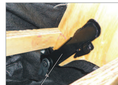
Fixations du dossier et de la charpente engagées
