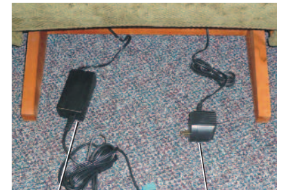
Transformador de energía de la cámara de refrigeración Transformador de energía para masaje y calor
