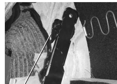
Levier de blocage en position « bloqué »
