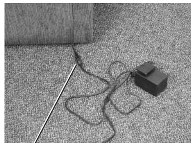
Conexión del transformador de energía
