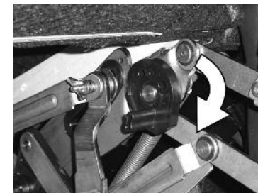
Tension minimale du repose-jambes
