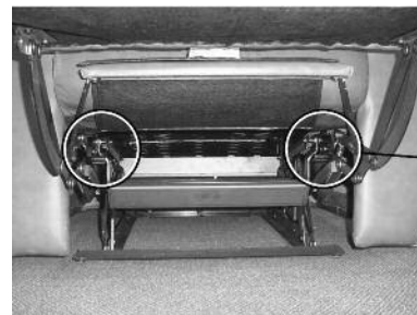
Ubicación de la rueda de ajuste, una en cada lado
