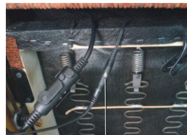
Connexion du transformateur électrique
